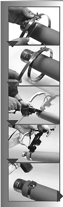
Schlaufe mit den Ohren zum Bandende auf das Band ziehen. Schelle formen, und Band auf Band legen. Schlaufe über beide Bänder ziehen, und das Bandende ca. 30 mm unter die Schlaufe biegen.
